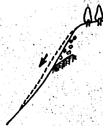
図-3 自然斜面の表層滑落
