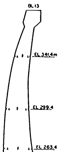
図-19 応力の計測例 (Cダム) (1)
