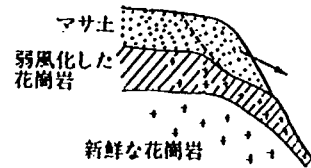
図-2 風化花崗岩斜面での崩壊形態の想定
