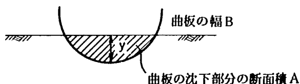
図 5-15 曲板載荷試験参考図
