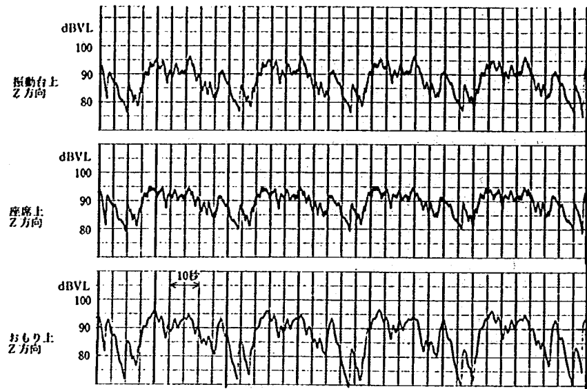
(a) 動吸振器内蔵型サスペンションシート (ばね2本) の 2速走行 (土道)
