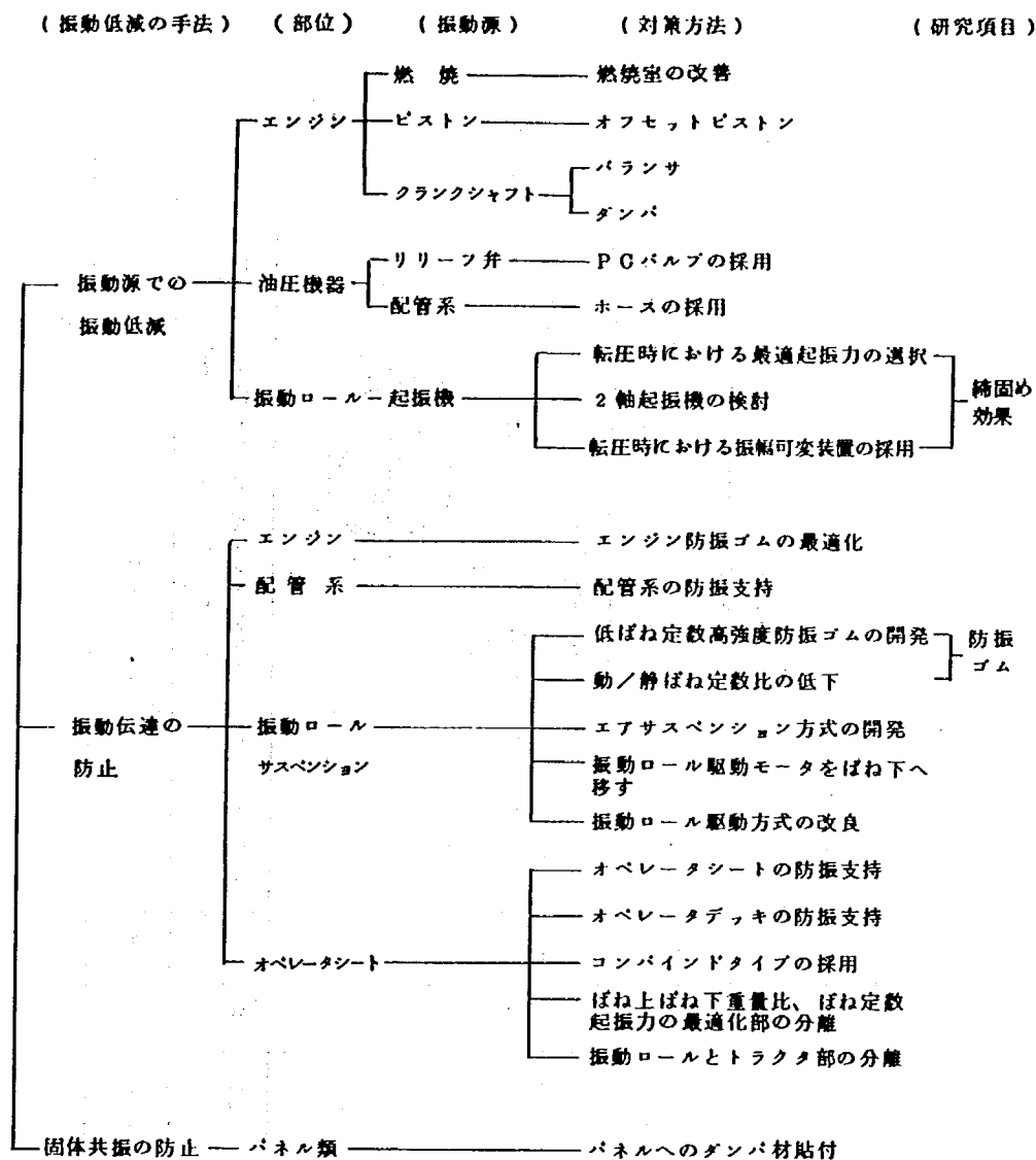
図3-9 振動ローラのオペレータ振動対策システムツリー
