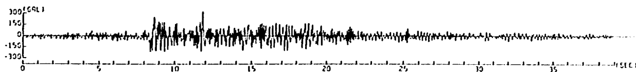
図 6-2-9 振幅調整した加速度波形, 最大加速度 a_{max}=324\text{gal}
