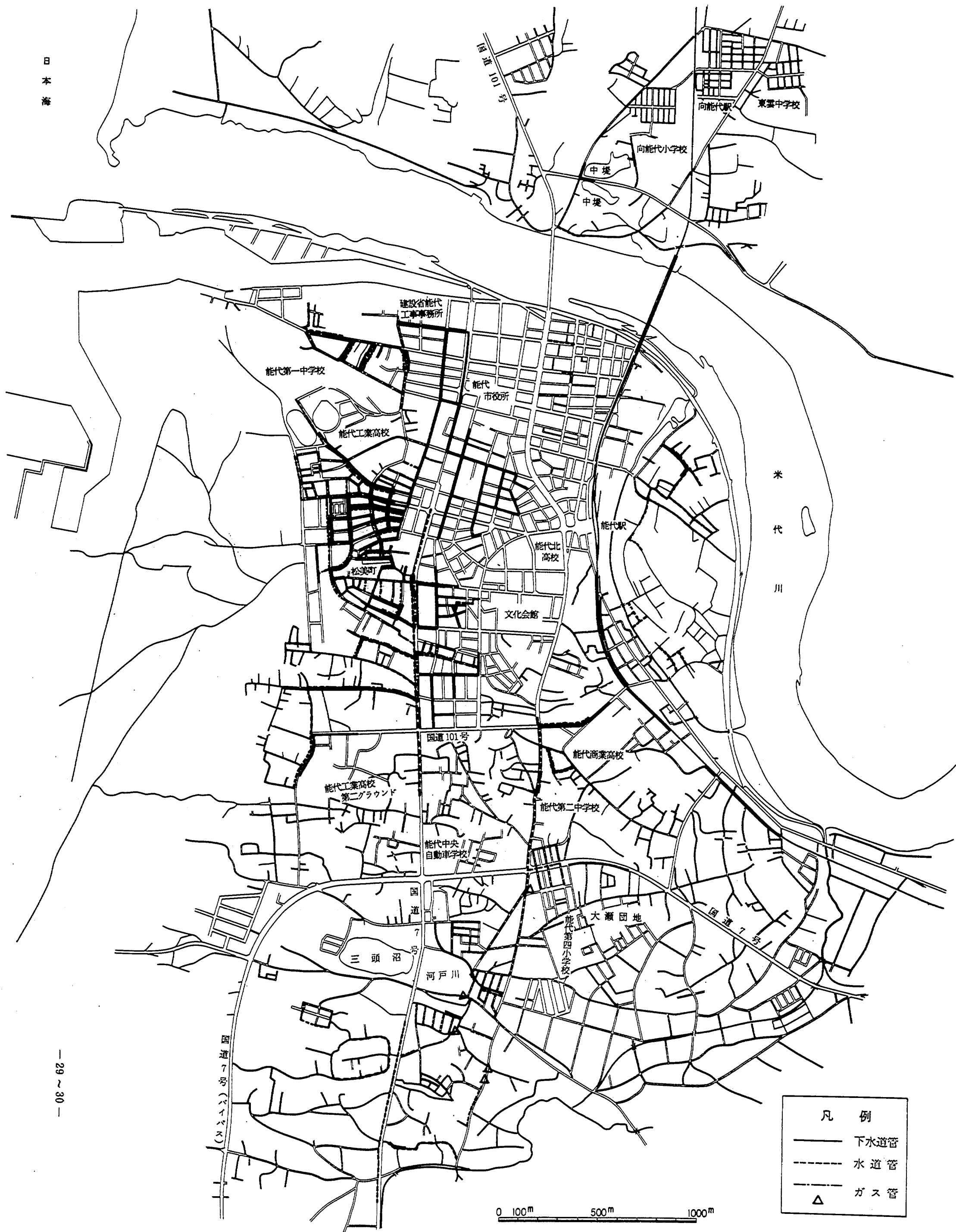
図 2.9 地下埋設管（下水道管、水道管、ガス管）の被害分布図
