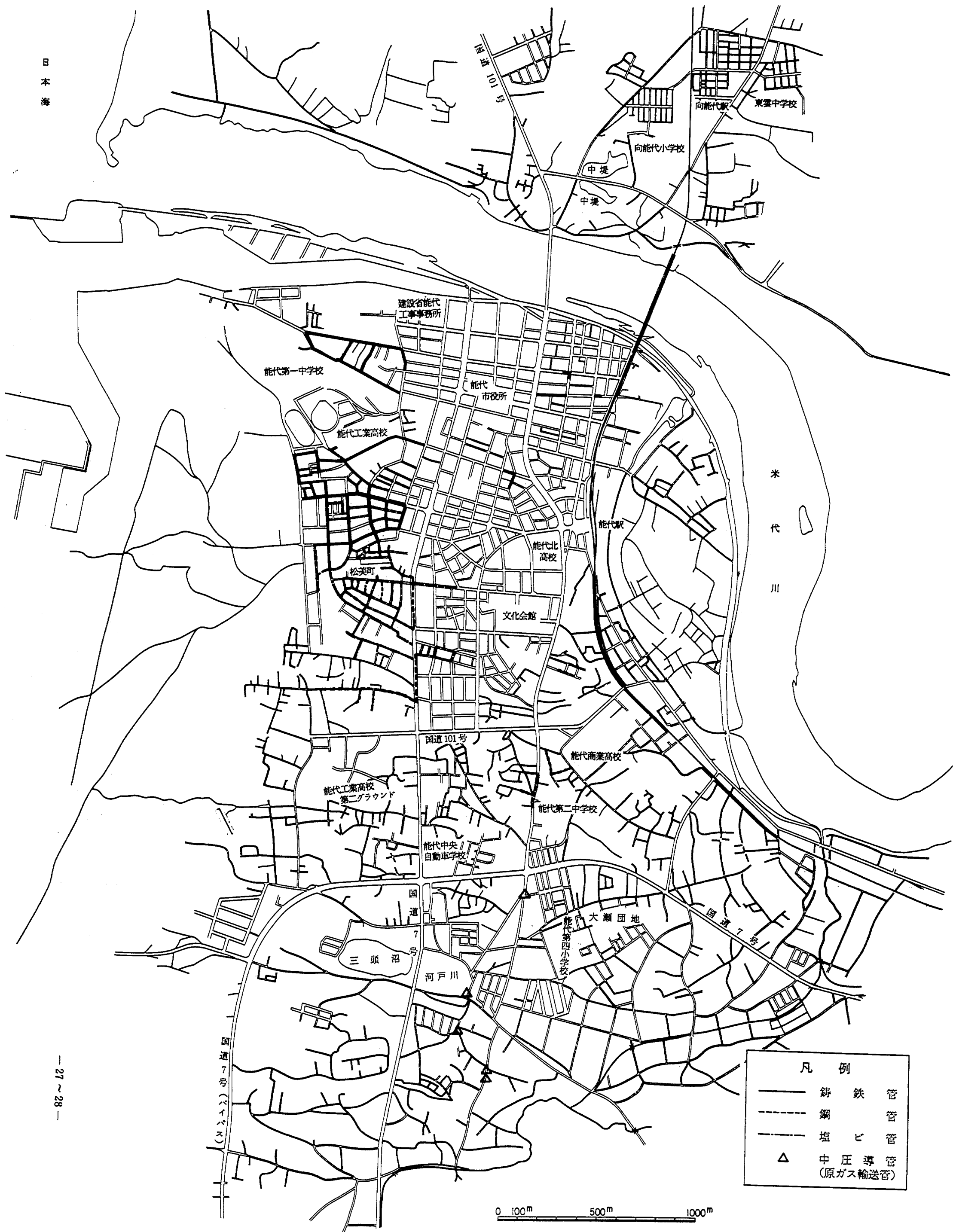
図2.8 ガス管被害箇所図
