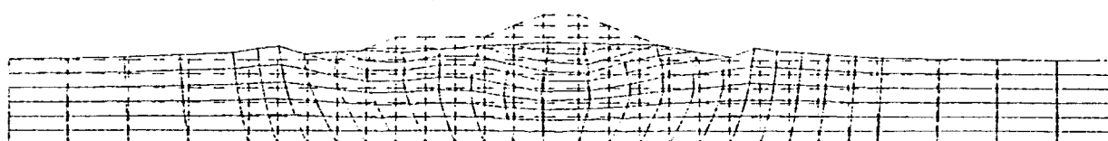
図-7.15 変形図(砂地盤モデル)
