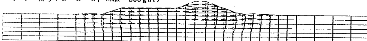
図-7.11 変形図 (粘土地盤)
