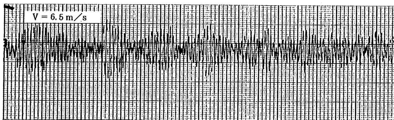
図-3.11.5 3次元模型応答波形(乱流Ⅰ・実験ケースB1-4221) (桁高比 H/B = 0.4 , m_2 , \delta_2 , \alpha = 0^\circ )
