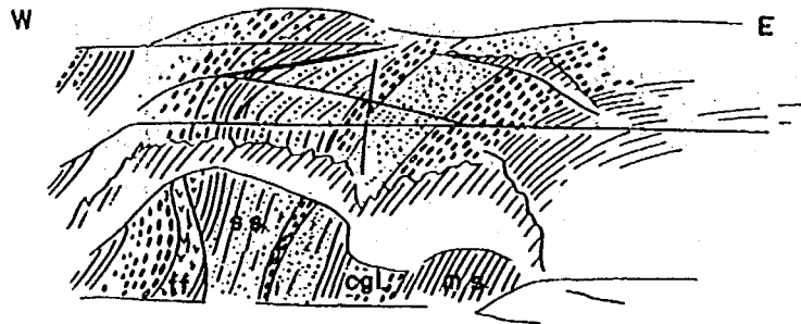
図-4 神戸市鈴蘭台における神戸層群のフレクチャー 8) 基盤岩の断層運動に伴って、被覆層である神戸層群がひきずられてきた構造である。
