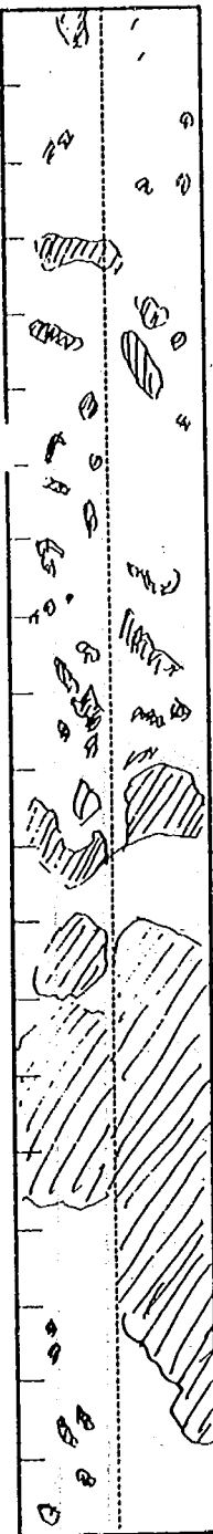
図-59-(3) ポストテンションにおける各PC鋼材の腐食状況
