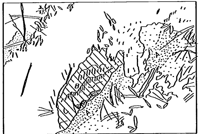
写真-100 F-1断層, E-16地点にみられる断層破碎帯
