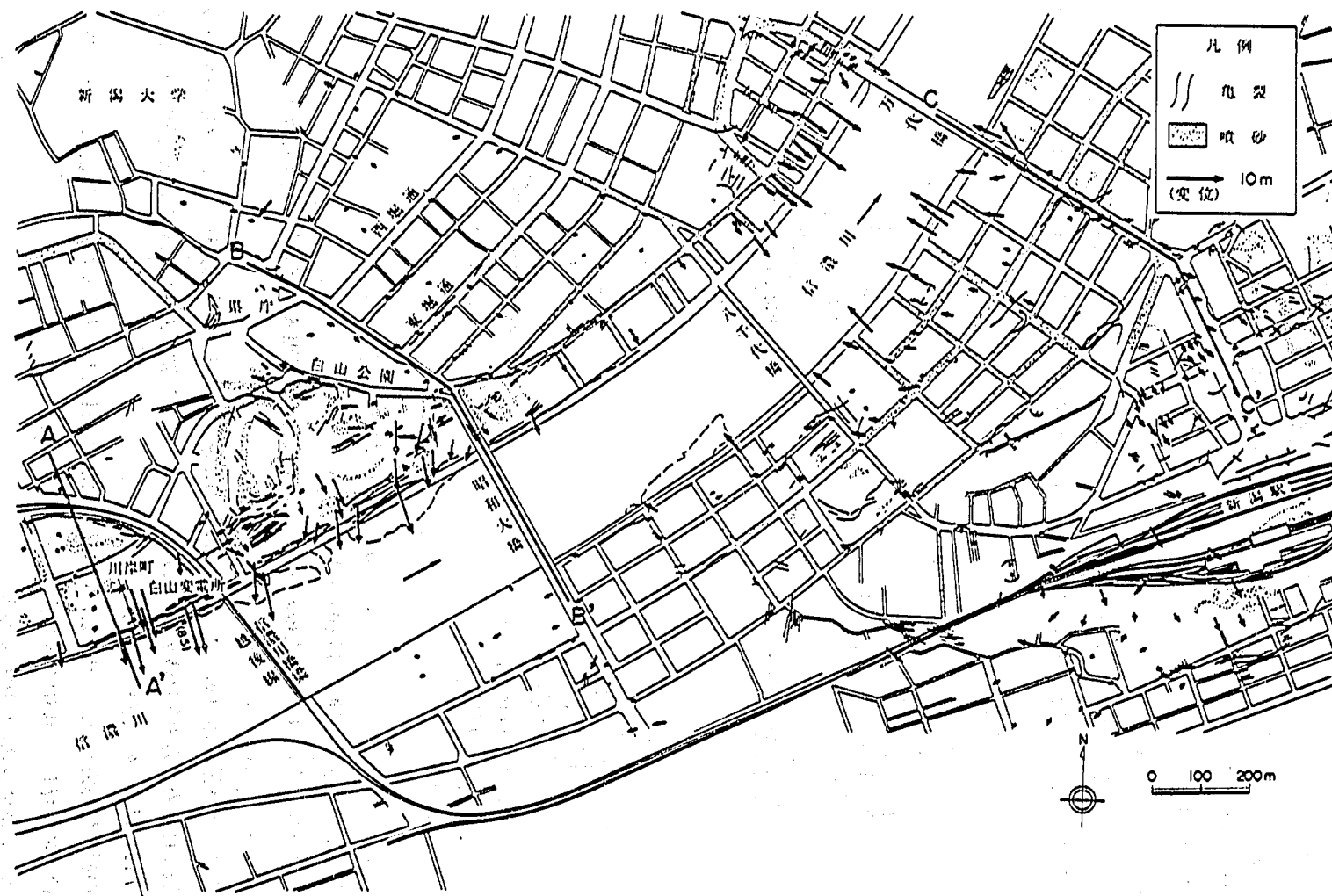
図-4 新潟地震による地盤の流動 5)
