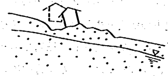
図-3 液状化にともなう被害形態の模式図
