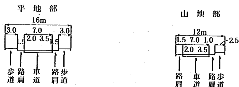
図4.4.17 道路の横断面の構成
