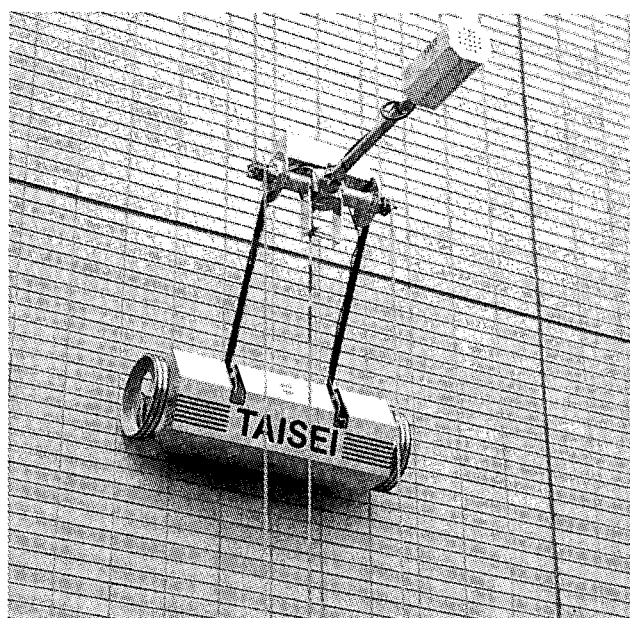
写真－2 外壁タイル検査ロボット
