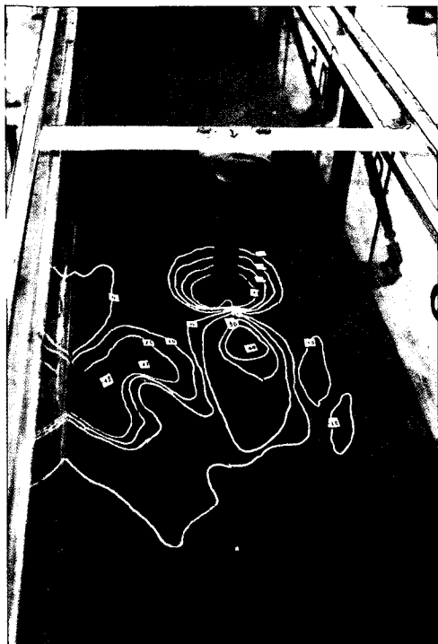
写真－3. 1 円柱橋脚模型周りの 洗掘状況
