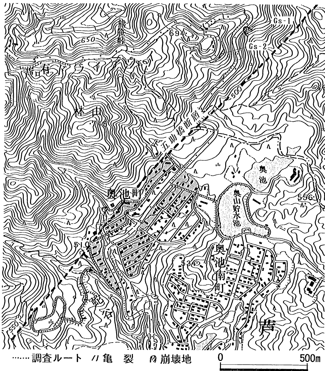
図-2.7 五助橋断層の調査ルートおよび道路面の亀裂、崩壊地の分布。図中の五助橋断層の位置は藤田・笠間(1982)から転記したものであり、必ずしも1:25000の精度はない。国土地理院発行1:25000地形図「宝塚」を使用。
