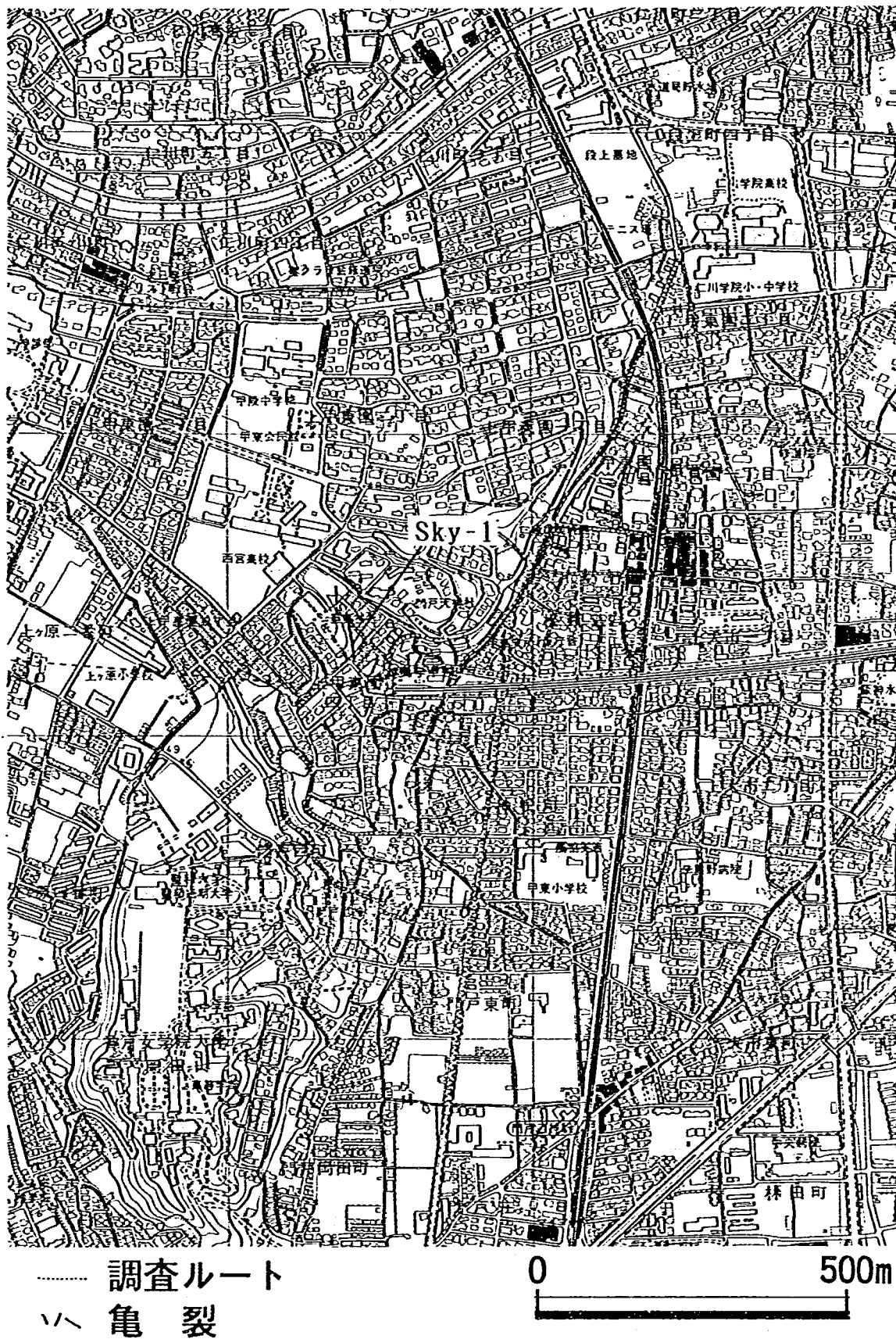
図-2.10 甲陽断層の南東側の断層の調査ルートおよび道路面の亀裂の分布。 国土地理院発行 1:10000地形図「甲山」を使用。
