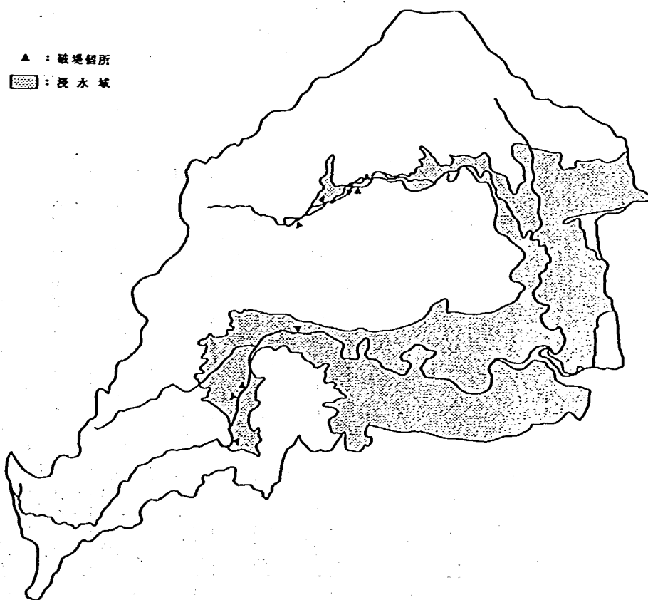
図-13 破堤箇所及び浸水域
