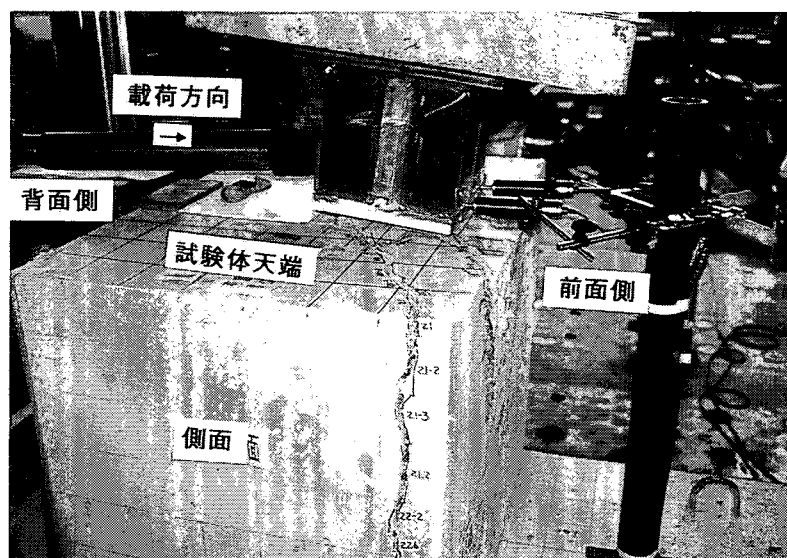
最終変位時ひび割れ状況 (BP-L-E試験体)
