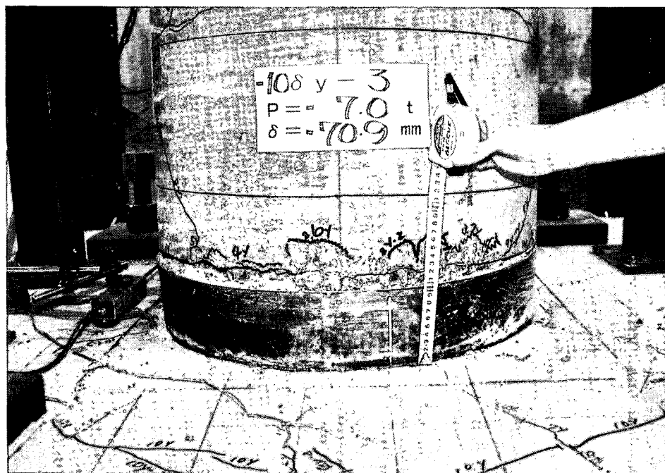
写真-参-16 ケース4 杭体損傷状況 (10 δ y: 載荷終了時、載荷方向)
