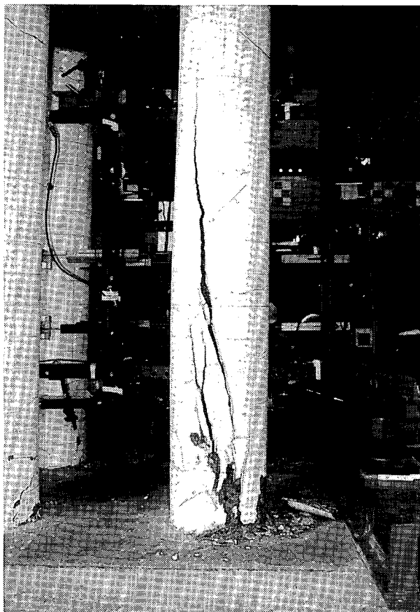
写真-3.3.2 杭①下部の損傷状況（ケース3、4 \delta y ）
