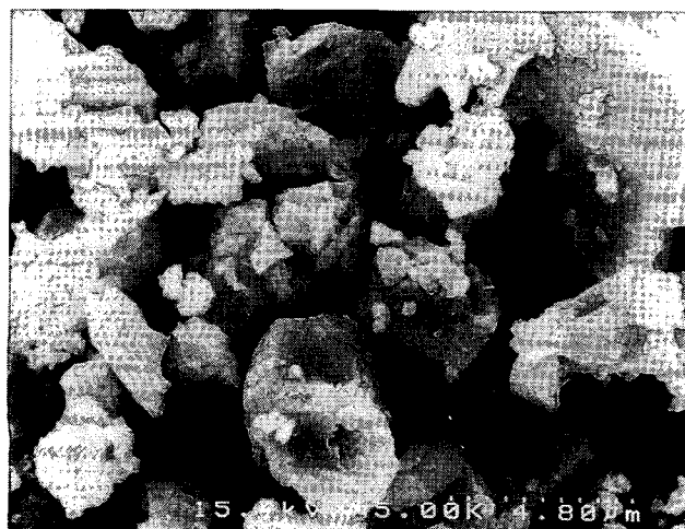
中庸熱セメント (M1) の顕微鏡写真 (×5000)
