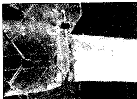
写真－2 出口円形 2 枚扉のヒレ状水脈 （ゲート開度=0.8, H/D=15 ）
