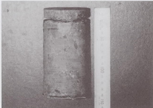
写真-6.6 コアの外観 (B-4, Cl: 9.7 kg/m 3 )
