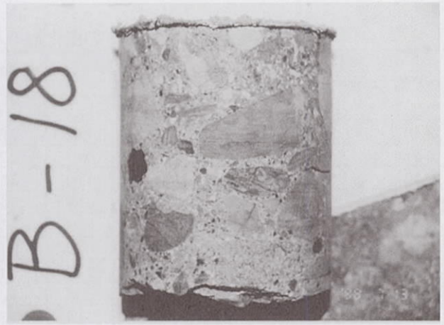
写真-6.8 コアの外観 (B-18, Cl: 10.4 kg/m 3 )
