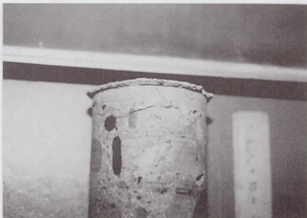
写真-6.7 コアの外観 (B-6, Cl: 6.9 kg/m 3 )
