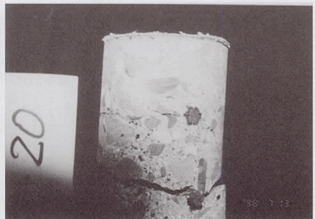
写真-6.10 コアの外観 (B-20, Cl: 7.6 kg/m 3 )
