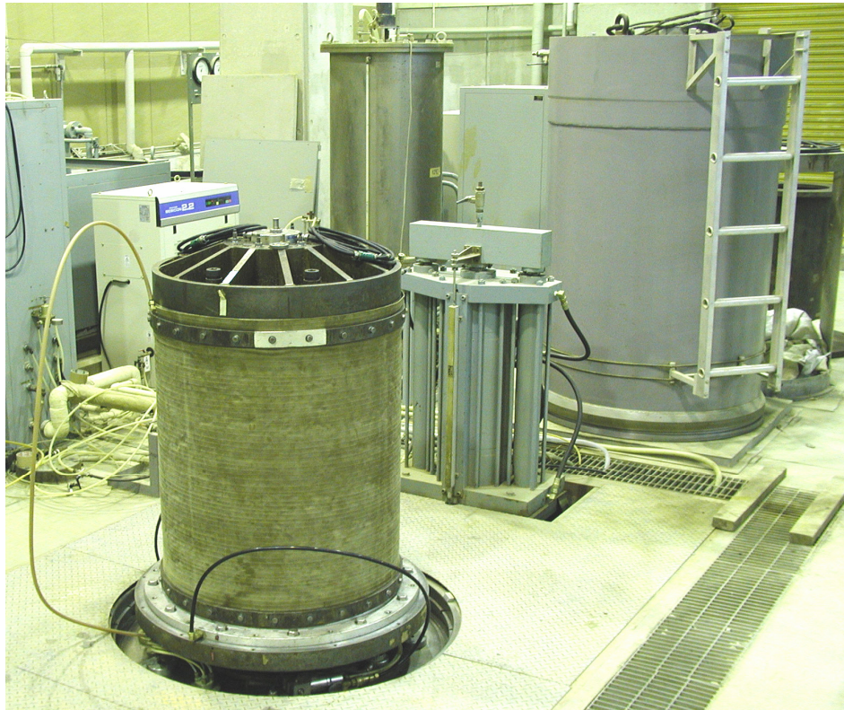
写真 1 大型中空ねじりせん断試験装置・供試体の全景
