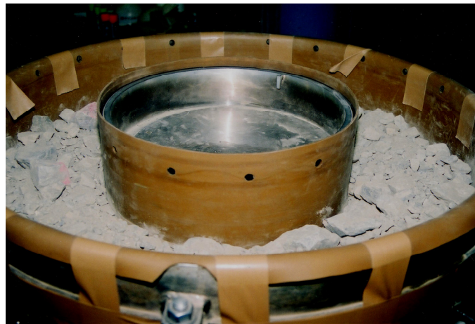
写真 2 大型中空ねじりせん断試験の供試体内部状況
