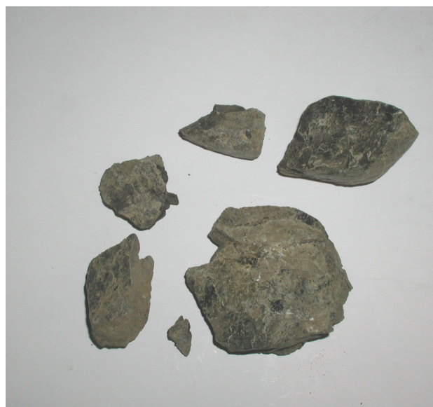
写真 5 C材 (丹生ダムロック材塊状輝緑凝灰岩碎石)
