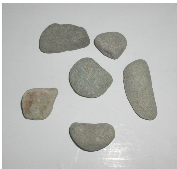
写真 4 B材 (忠別ダムシェル材安山岩質河床砂礫)
