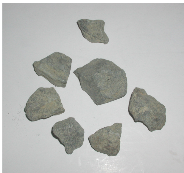
写真 3 A材 (三国川ダムロック材斑れい岩碎石)
