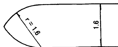
図-3 先鋭とした橋脚等の先端形状
