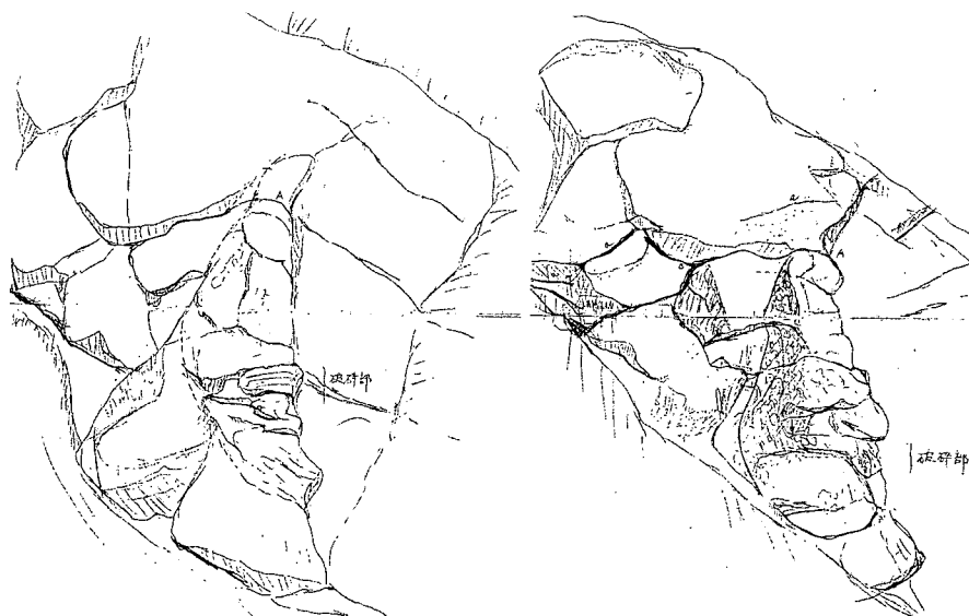
図 3.25 亀裂が発達した岩盤斜面の例 (安瀬地区)
