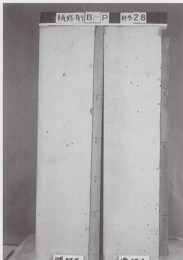
付属写真－6 吹付け－Ec－プライマー①－（順打ち、逆打ち）
