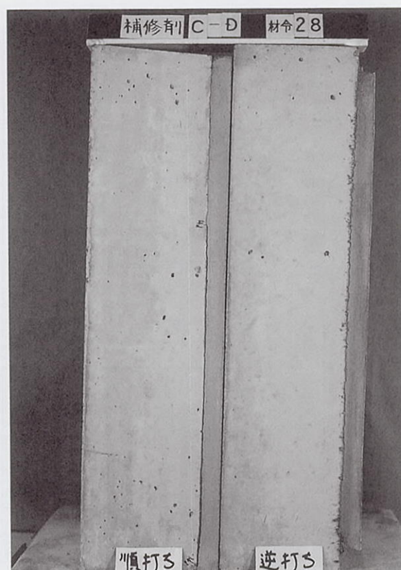
付属写真-8 吹付け-Epa-乾燥-(順打ち、逆打ち)
