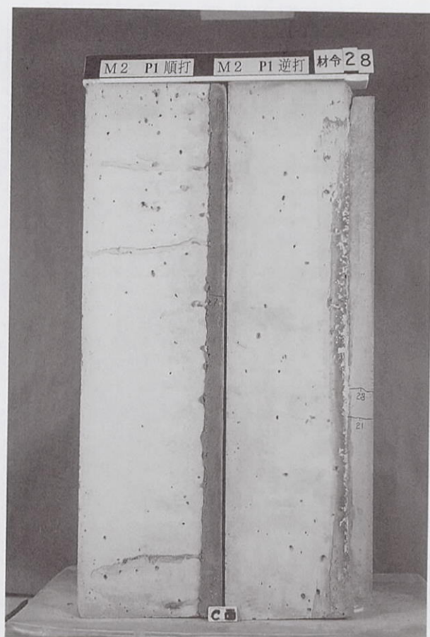
付属写真-19 注入-GMc-プライマー①-(順打ち、逆打ち) GMcの写真中の表記はM2
