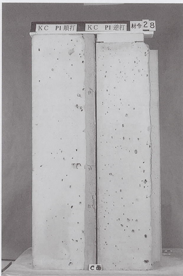
付属写真-26 注入-GKpa-プライマー①-(順打ち、逆打ち) GKpaの写真中の表記はKC
