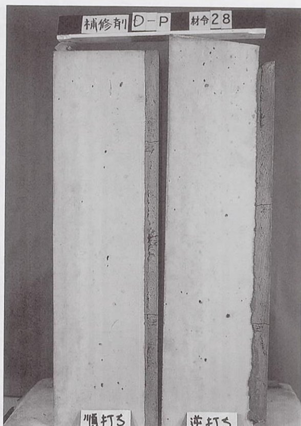
付属写真-7 コテ塗り-Ec-プライマー①-(順打ち、逆打ち) Ecの写真中の表記はD
