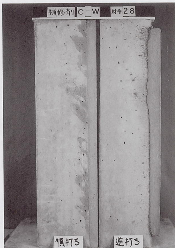
付属写真－9 吹付け－Epa－湿潤－（順打ち、逆打ち） Epaの写真中の表記はC
