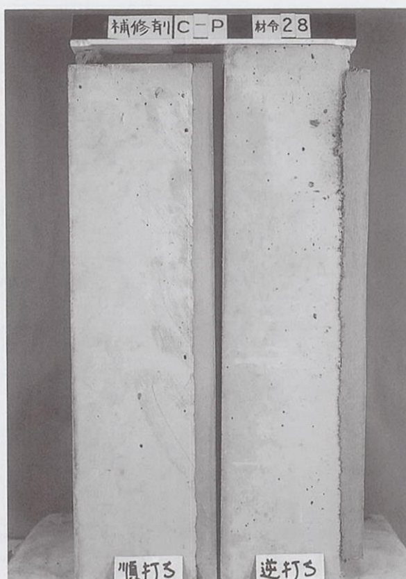
付属写真-10 吹付けEpaプライマー①-(順打ち、逆打ち) Epaの写真中の表記はC
