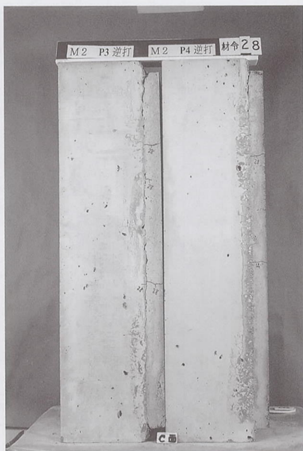
付属写真-20 注入-GMc-(プライマー③、④)-逆打ち GMcの写真中の表記はM2 プライマー④は酢酸ビニル系
