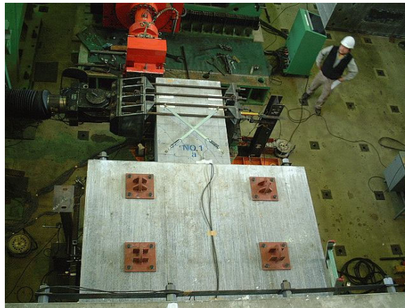
写真-3.3.1 せん断変形量の計測方法の一例
