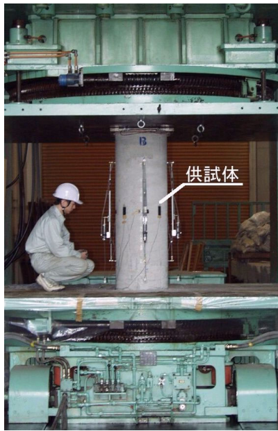
(a) 大型模型を用いた圧縮载荷実験
