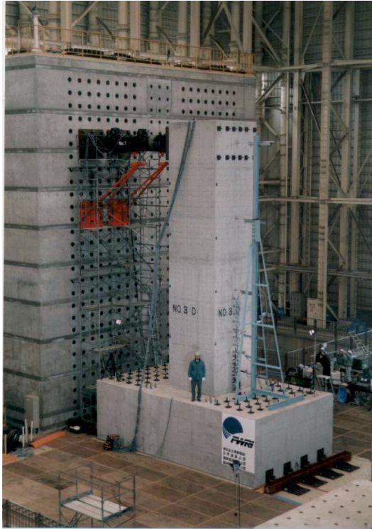
写真-3.2.1 実大規模の大型模型に対する載荷実験
