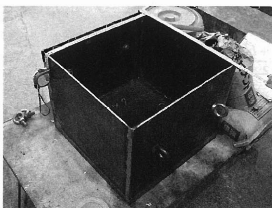
写真-2.3 鉛直載荷実験用模型 (外枠鋼板)
