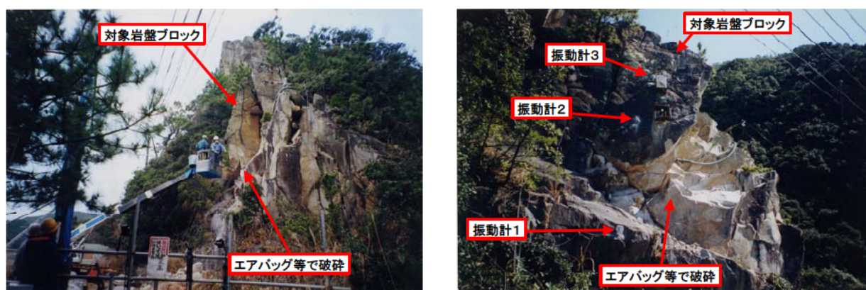
写真-6.1.1 人工的に岩盤ブロックを不安定化させて計測を行った事例の
