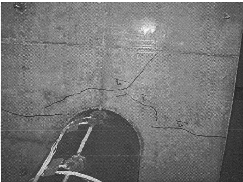
写真- 3.1.2 3列供試体 上フーチング底面ひびわれ状況(試験終了時)
