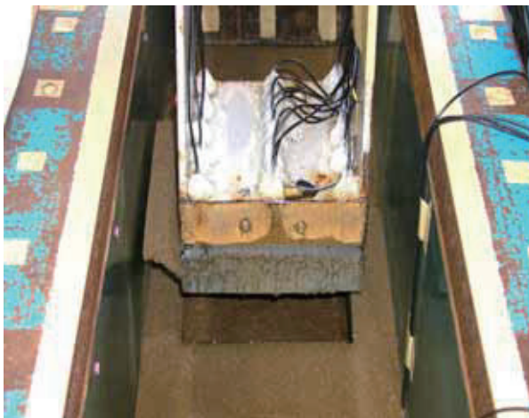
写真-10 止水スカーツを用いた場合の 供試体撤去後の地盤
