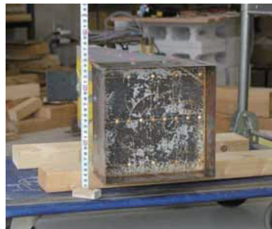
写真-3.6 止水構造（止水鋼板：底面）
