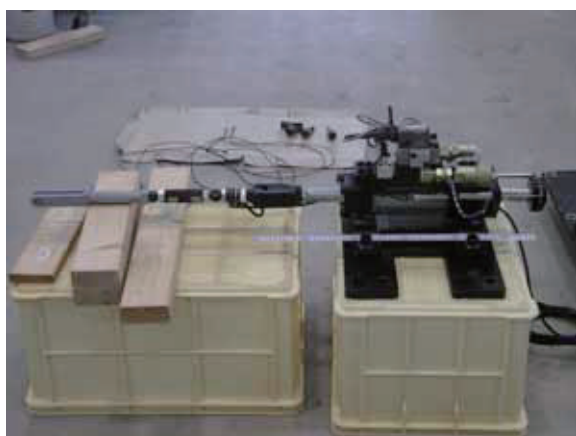
写真-3.8 遠心場急速載荷装置
