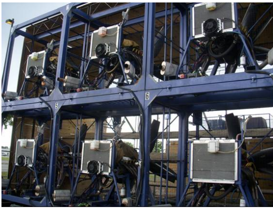
写真—25 Wall of Windの送風機
