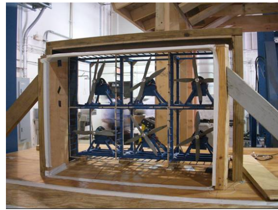
写真—26 Wall of Windの検証用試験装置
