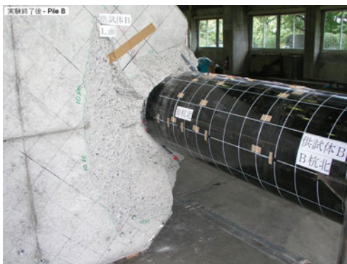
写真-5.7 Case F：試験終了時の杭とフーチング 接合部の損傷状況
