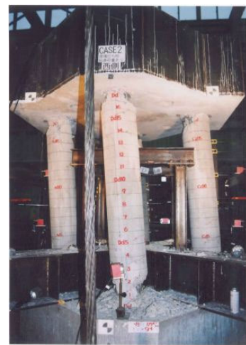
写真-5.6 Case 45 ° 載荷試験実施状況
