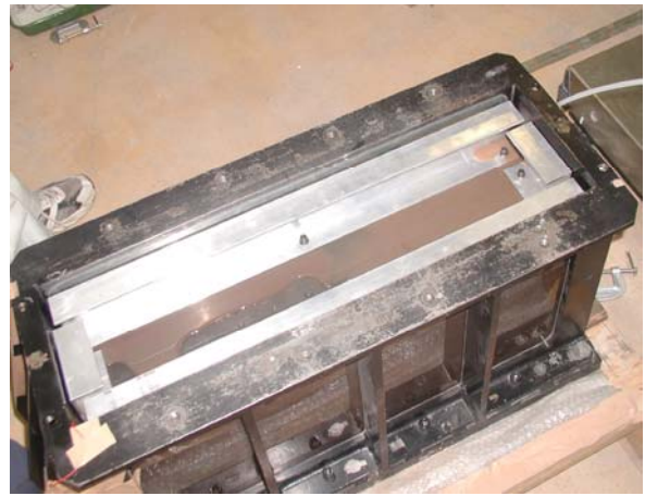
(b) 载荷プレート設置
