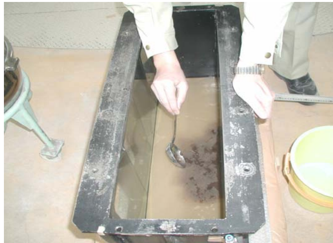
(a) スラリー状泥炭投入状況
