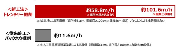
図-7 施工速度の比較(駐車帯部)
