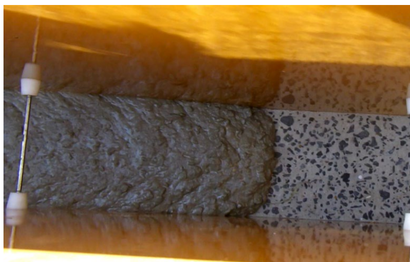
写真-4.5.18 流動先端の状況
