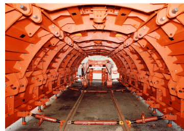
【分離後のスキンプレート部】
