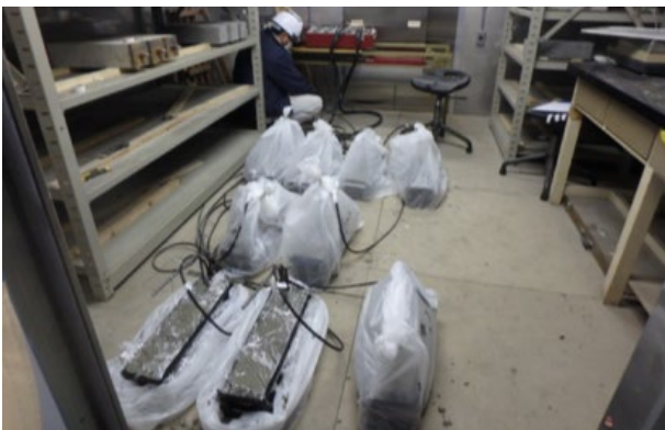
写真-4.5.5 ひずみの測定状況 (材齢7日まで)
