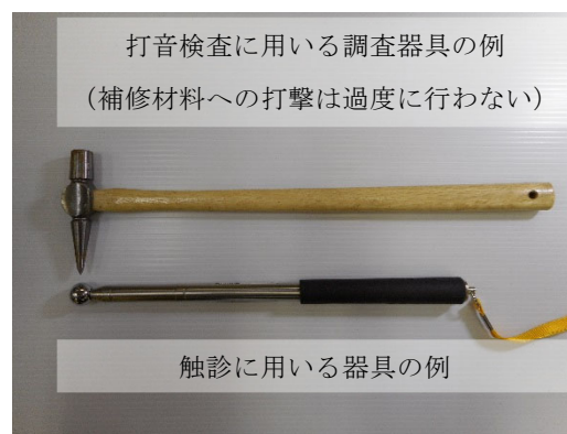
解説 写真-5.2.1 触診や打音による調査に用いる器具の例
