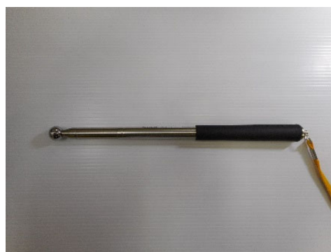
解説図-5.3.2 触診による調査に用いる器具の例〔被〕
