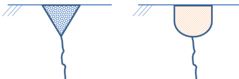
解説 図-3.3.3 Vカット（左）とUカット（右）の例
