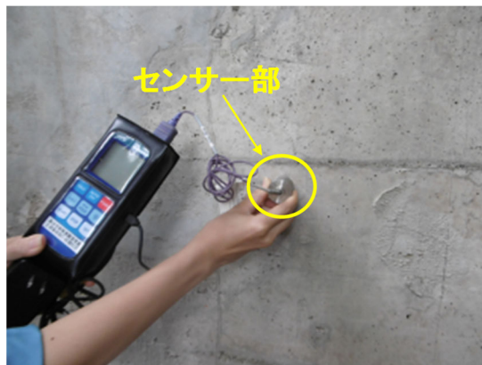
図2 接触式表面温度計を用いた表面温度の測定例〔被・含〕
