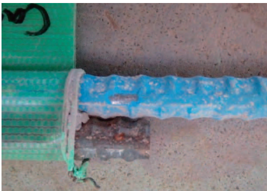
写真-5.9 塗膜剥離状況 (条件 5)
