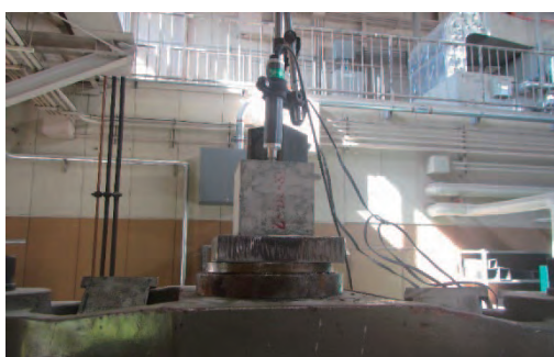
写真-4.11 引抜き試験状況
