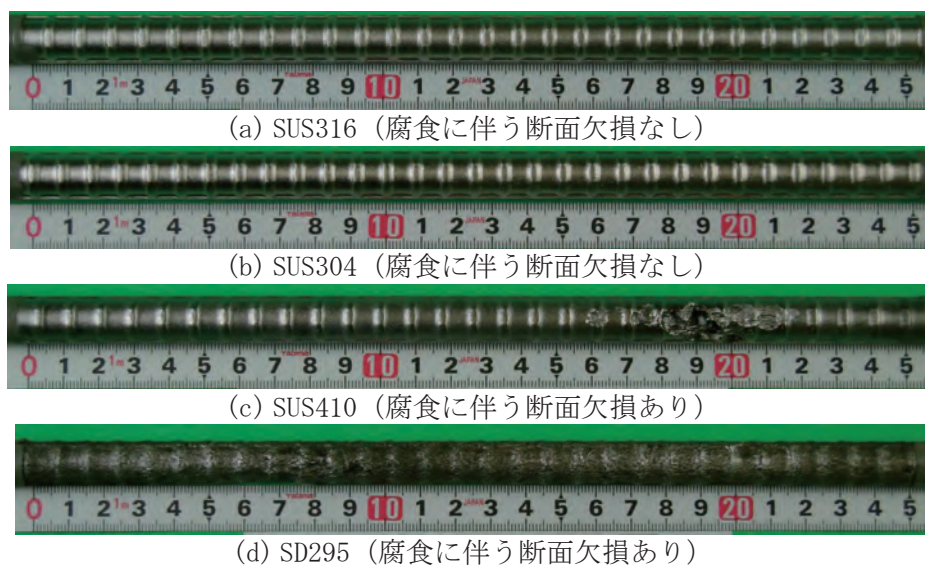
写真-4.2 暴露3年後の鋼材の断面欠損状況の例 (塩化物イオン量 25kg/m 3 )
