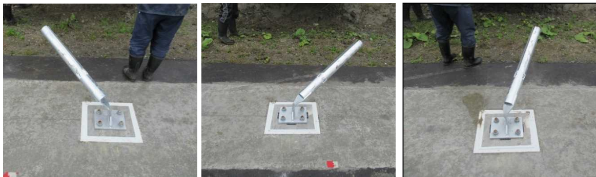
写真-3.15 支柱衝突実験結果（左：P7、中：P8、右：P9）
