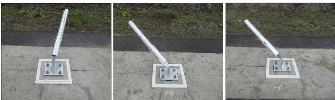
写真-3.14 支柱衝突実験結果（左：P4、中：P5、右：P6）
