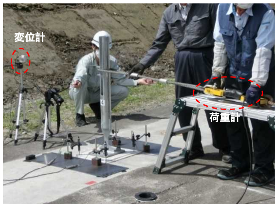
写真-3.19 荷重計・変位計設置状況
