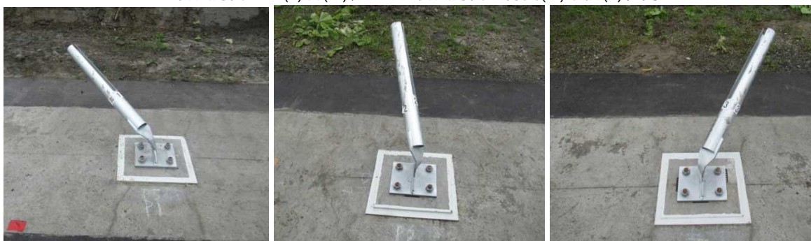
写真-3.13 支柱衝突実験結果（左：P1、中：P2、右：P3）
