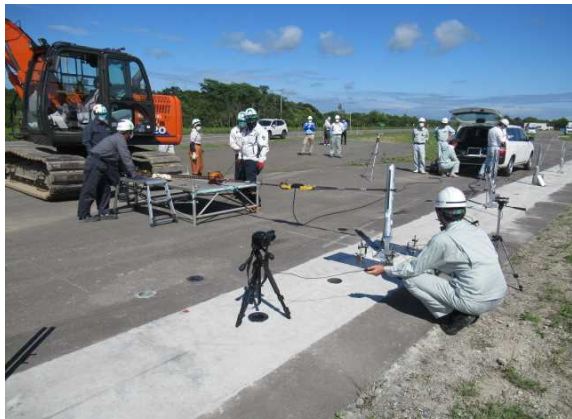
写真-3.18 支柱静荷重試験全景
