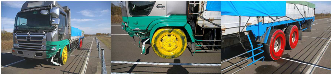
写真-4.5 大型車の損傷状況
