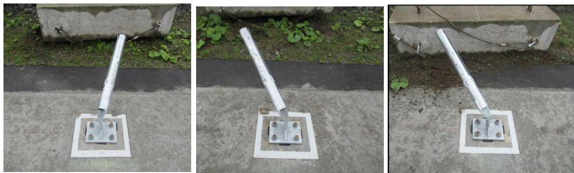
写真-3.16 支柱衝突実験結果（左：P10、中：P11、右：P12）
