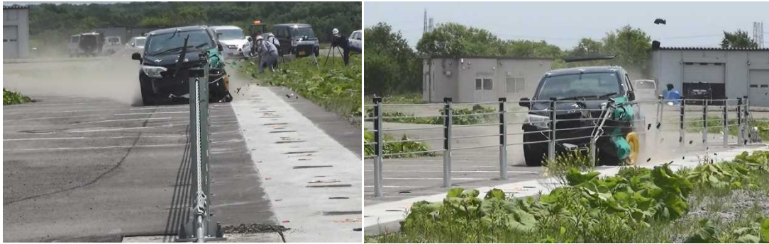
写真-4.6 性能確認試験における乗用車衝突時の状況
