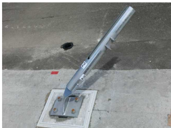
写真-3.20 支柱静荷重試験結果（P2）
