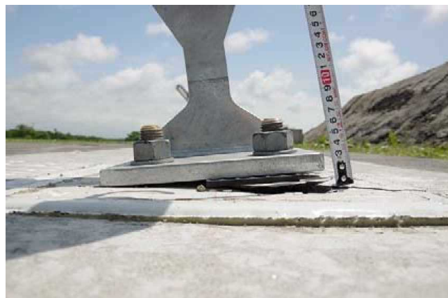
写真-3.21 支柱静荷重試験結果（P10）
