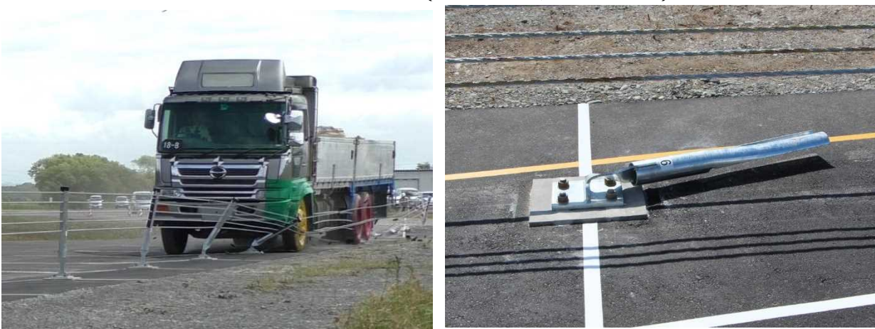
写真-2.11 性能確認試験（車両衝突時の状況）
