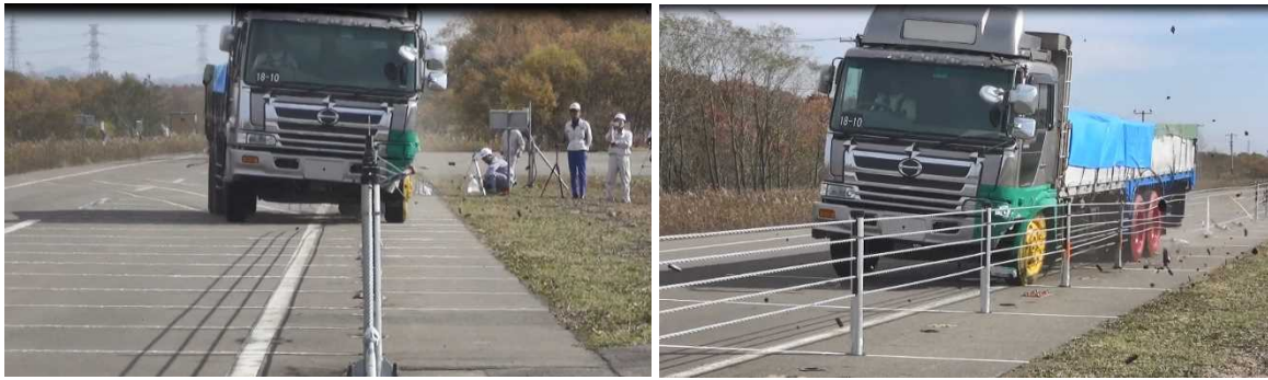
写真-4.3 性能確認試験における大型車衝突時の状況
