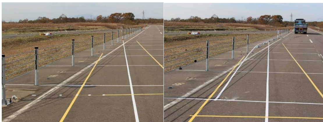
写真-4.1 ワイヤロープ式防護柵設置状況（左：大型車試験前、右：大型車試験後）
