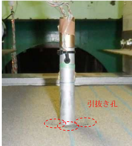
写真-1 既設杭の引抜き後の実験状況
