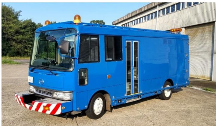
写真 1.1.1 移動式たわみ測定装置 (MWD)
