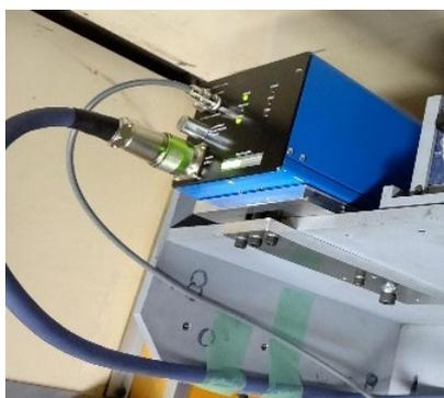
写真 4.1.1 試作機の架台剛結状況
