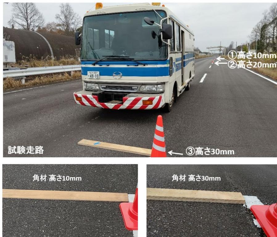
写真 4.3.1 段差走行試験の様子
