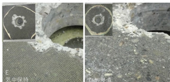
図-29 押抜き試験後の供試体の例 (E)
