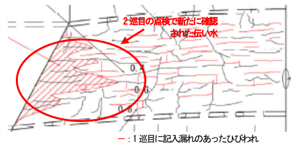
図-5 坑口付近頂版への伝い水の例
