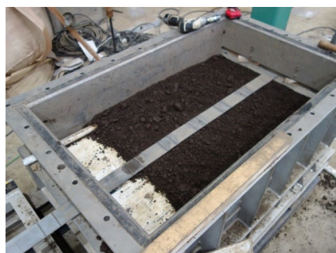
図-10 土中引抜き試験機 (補強材設置状況)
