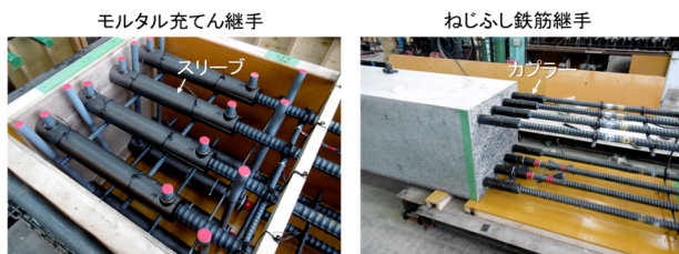
写真-2 機械式鉄筋継手の配置状況例
