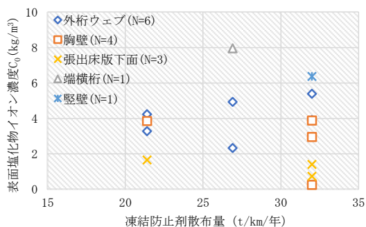
図-17 漏水跡がある箇所における凍結防止剤散布量と表面塩化物イオン濃度の関係
