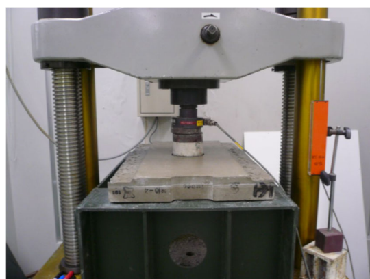
図-23 押抜き試験の様子
