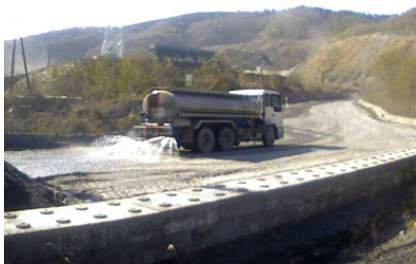
図-03 碎石場での散水による粉じん対策。
