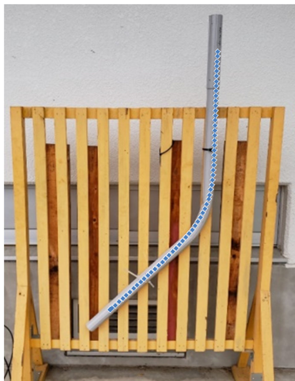
図 3.4-16 屈折角 45.9 度 ガイド管写真と測定値軌跡比較
