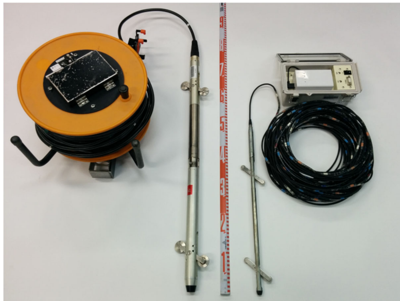
図 3.3-4 従来型の挿入式計器と新型の小型挿入式計器の外観
