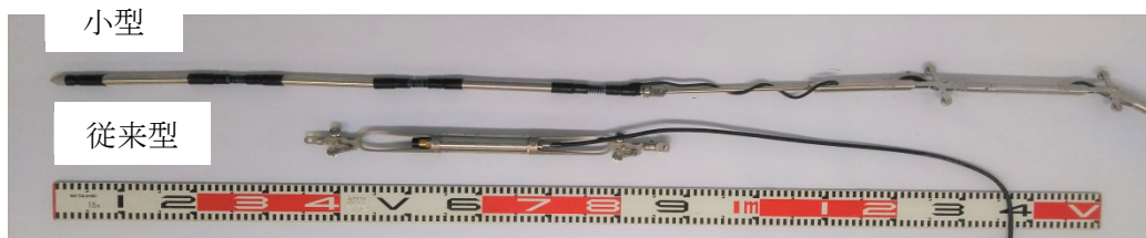
図 3.5-1 従来型と小型設置式計器の外観
