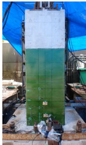
写真-1 補修を施した後のAF試験体
