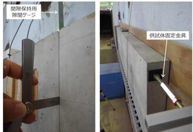
図-7 間隙ゲージによる間隙保持状況 (左) と供試体固定状況 (右)
