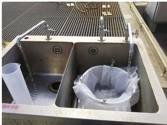
図-22 下水放流水取水設備からのろ過作業の様子
