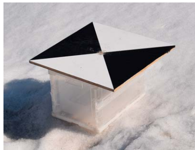
図 25 対空標識の例 (地表から高さを設けている)
