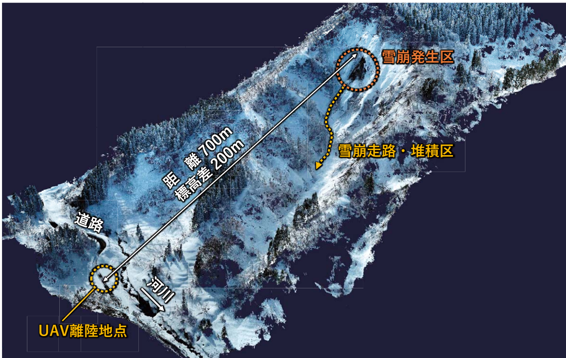
図 31 SfM 処理により作成した三次元モデル
